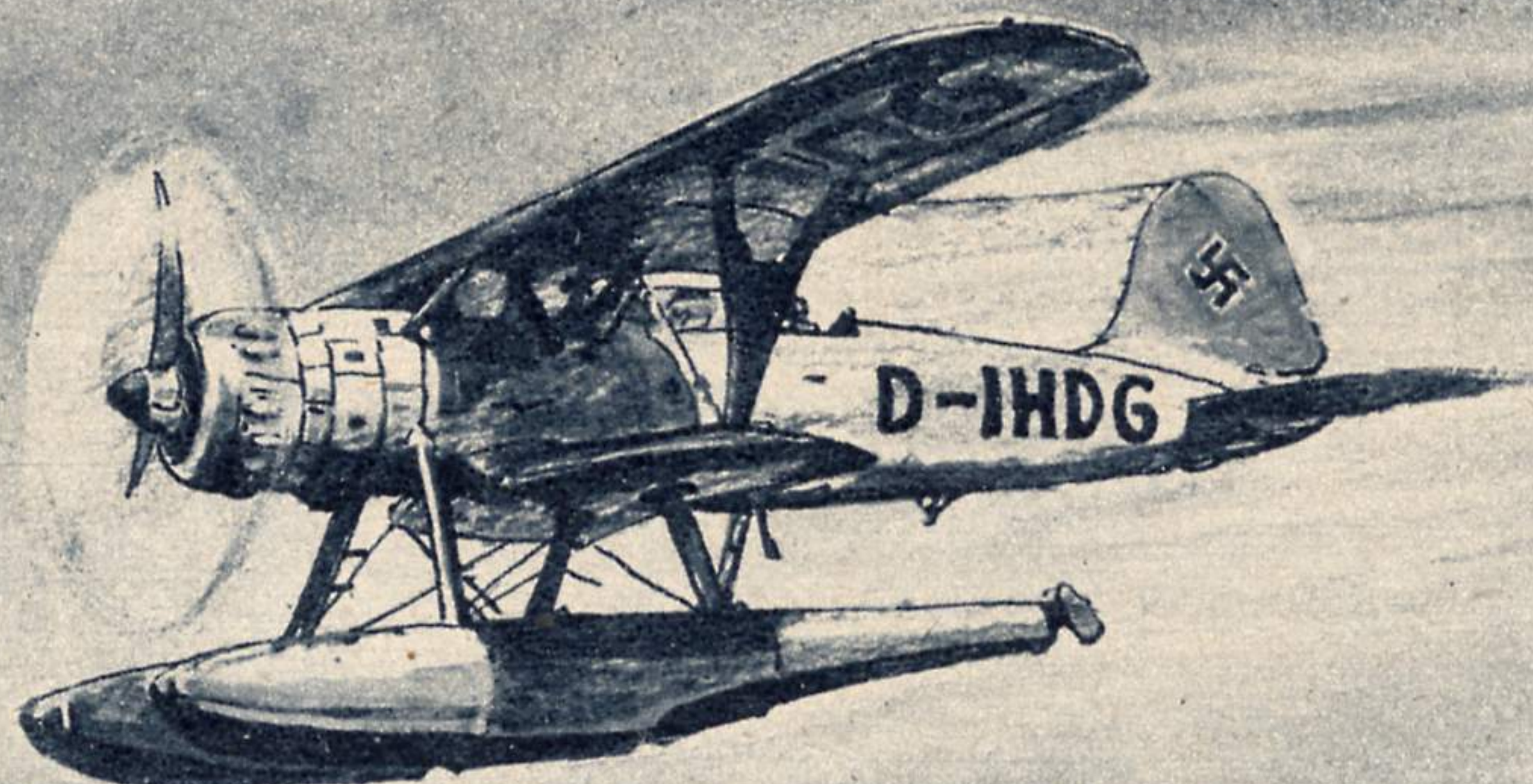
He 114 Aufklärungs-Schwimmerflugzeug schleuderstartfähig, einmotorig, Besatzung 2 Mann. 1 starres durch den Luftschraubenkreis feuernendes MG und 1 bewegliches MG auf Speziallafette. Gehänge für 2 Bomben von je 50 kg. Höchst- geschwindigkeit in 850 m 292 km/h, Marschge- schwindigkeit in 2000 m 230 km/h, Landegeschwin- digkeit 95 km/h, Steigzeit auf 2000 m 8 Min., Gipfelhöhe 4800 m, Reichweite 1125 km
