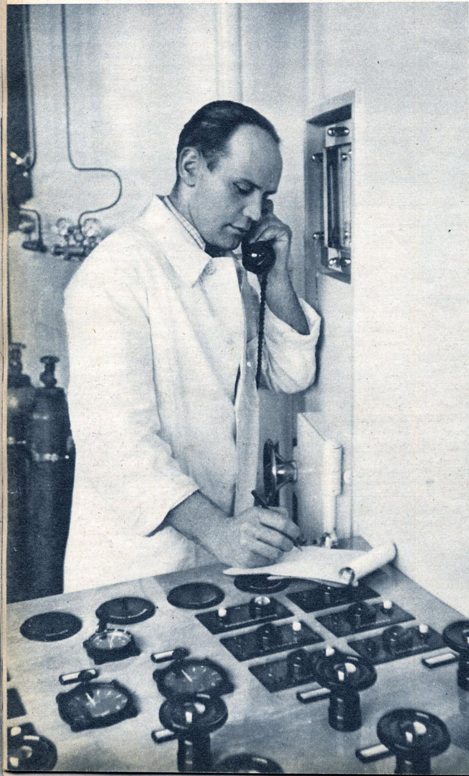
irgendwelchen Zwischenfällen den Versuch abubrechen. Ebenso hat der Versuchsleiter in der Kammer die Möglichkeit, die Pumpen auszuschalten und durch ein Ventil wieder Luft in die Kammer einströmen zu lassen, falls durch ein Versagen des technischen Assistenten eine Gefahrenquelle entstehen sollte.
