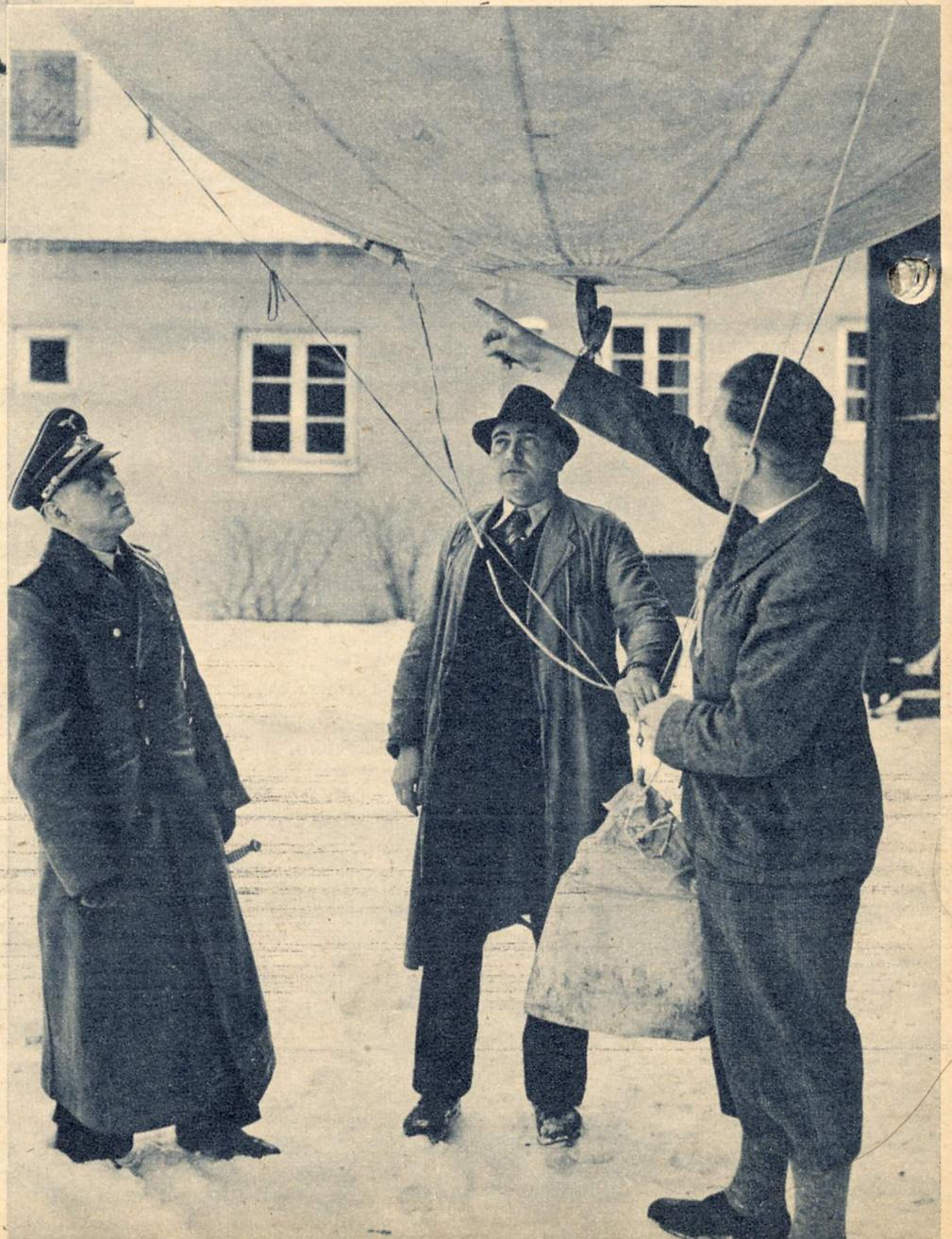
Das obige Bild zeigt die ganze Anlage des englischen Flugblattballons. Es besteht aus gummiertem Baumwollstoff, der mit Wasserstoffgas gefüllt ist. Unter dem Ballon hängt ein Holzrahmen mit den zum Abwurf bestimmten Flugblättern
