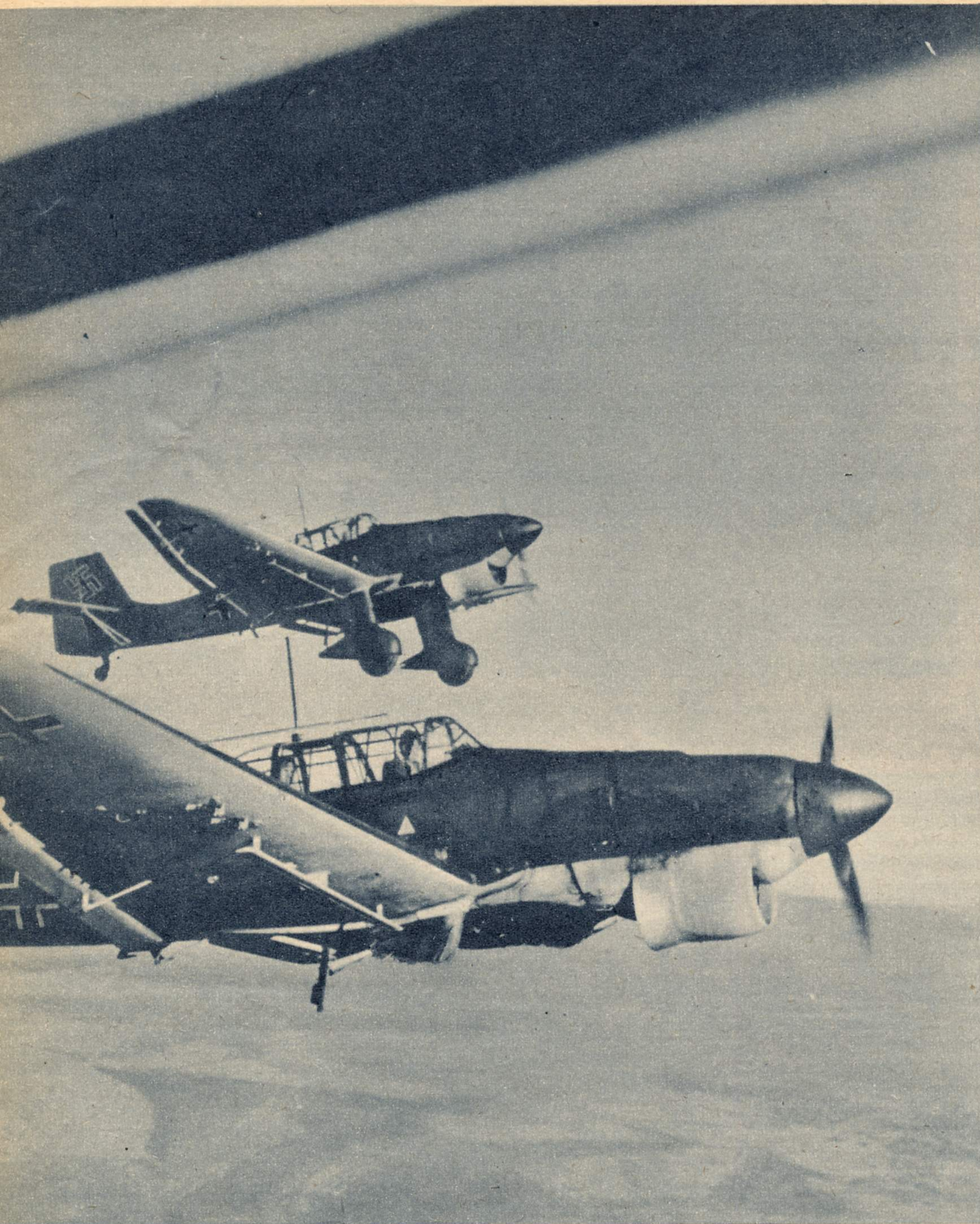
Bei einem Angriff auf die Westerplatte kam eines der eingesetzten Sturzkampf- flugzeuge beim Abfangen dem Wasser zu nahe. Dabei verlor es das gesamte Fahrwerk; außerdem wurde die Luftschaube leicht verbogen. Das Flugzeug flog damit im Verband zu dem noch über 120 km entfernten Heimathafen zurück und landete glatt auf der Rumpfunterseite
