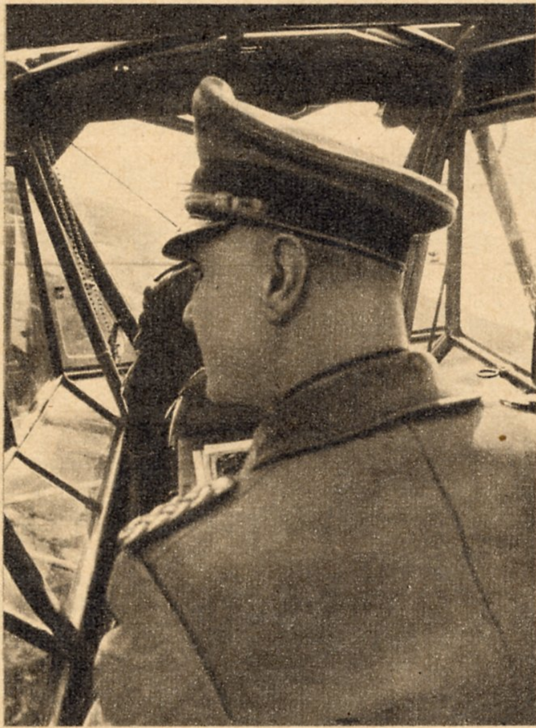
Diese Aufnahme, die den General im Anflug zu seinem Abschnitt zeigt, gibt deutlich die gute Sicht wieder, die man aus diesem Flugzeug hat. Die Kabine ist allseitig verglast, so daß unbehindert nach allen Richtungen beobachtet werden kann
