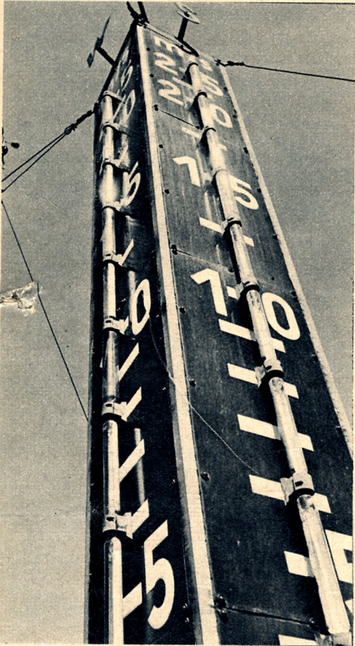
Oben: Dieser hohe Turm, der wie ein Riesen-Thermometer aussieht, ist der weithin sichtbare Windgeschwindigkeits-Anzeiger
