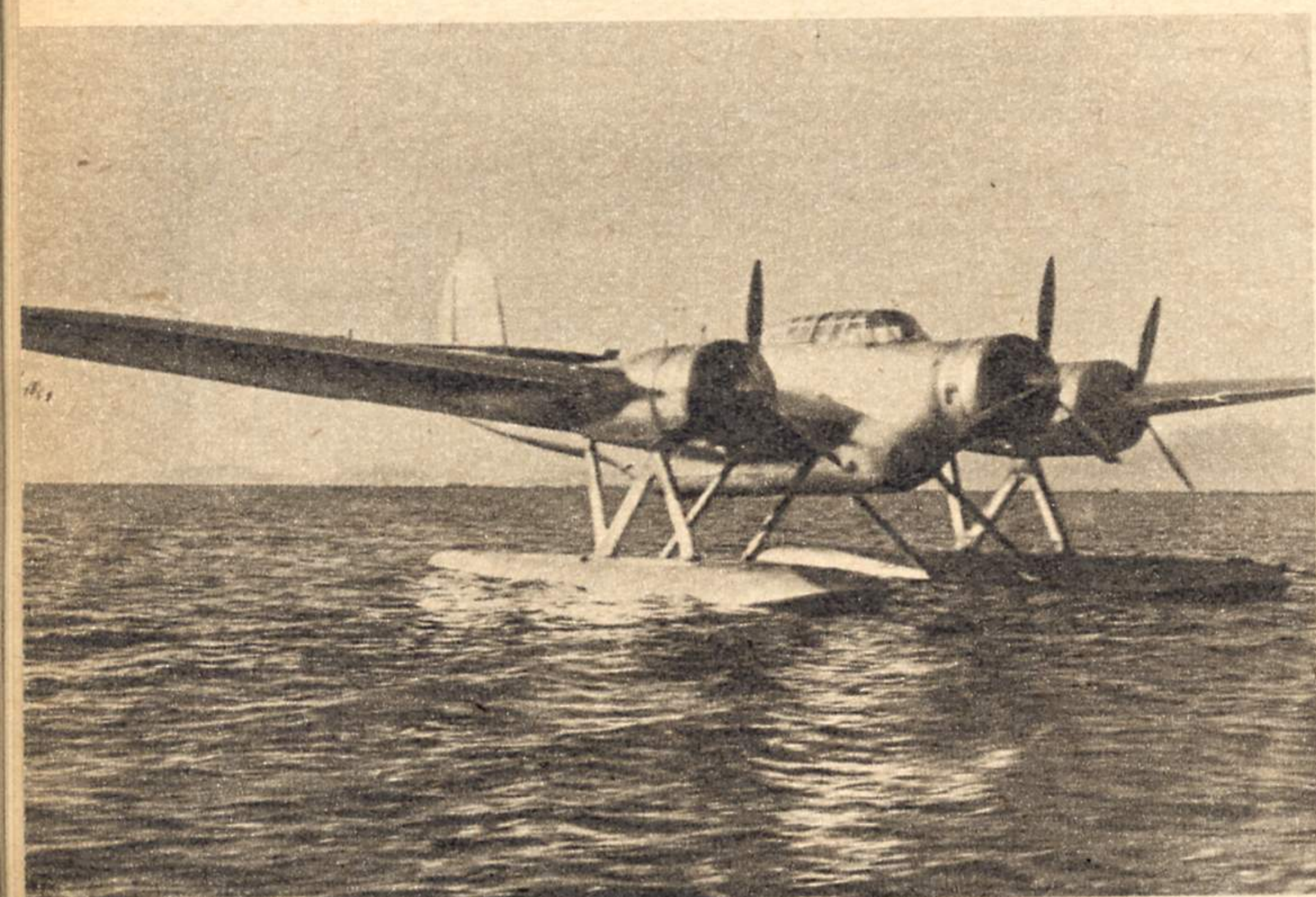
Mehrzwecke-Seeflugzeug Cant. Z 506B für Bomben- und Torpedowurf, dreimotorig, besonders für Fernaufklärung
