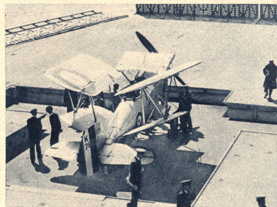
Da das Deck für den Start und die Landung frei bleiben muß, werden die Flugzeuge in einem großen Fahrstuhl zu den Laderäumen befördert
