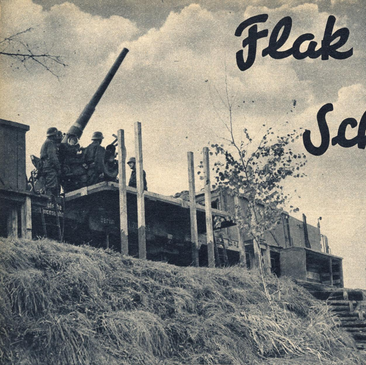
Zur Verstärkung der Schlagkraft unserer Flakwaffe und zur Erhöhung der Einsatzmöglichkeiten werden jetzt auch Flakgeschütze auf Eisenbahnwagen aufgestellt. Sie können schnell über große Entfernungen verschoben werden und dienen ganz besonders dem Schutz der deutschen Großstädte, wo ein dichtes Eisenbahnnetz den schnellsten Einsatz ermöglicht
