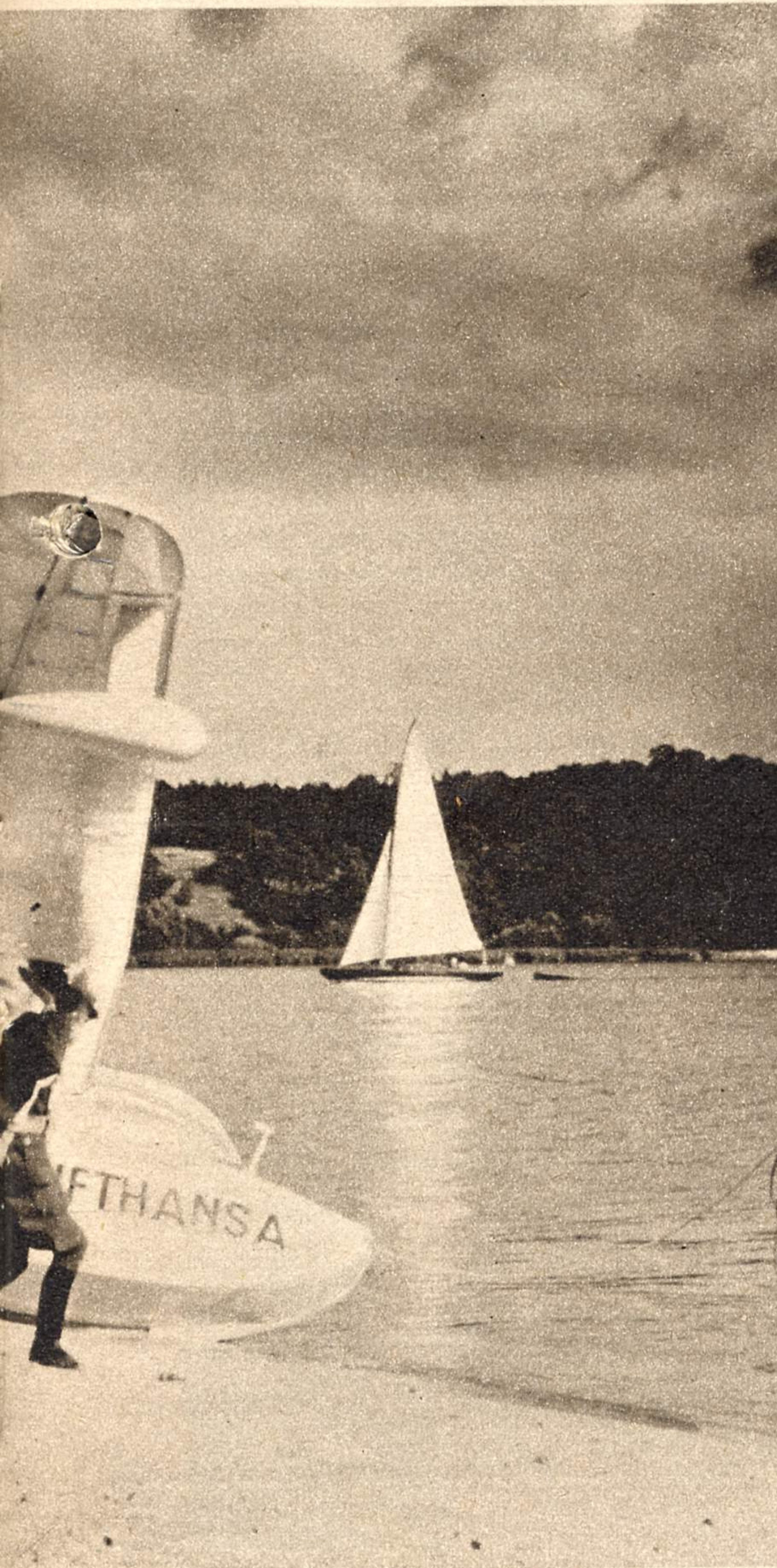
Mit vereinten Kräften wird Jachtmanns Flugzeug zu Wasser gebracht. Das Bild läßt erkennen, wie der Flugzeugrumpf sowohl als Kiel wie als Kufe für den Start zu Wasser und zu Lande ausgebildet ist
