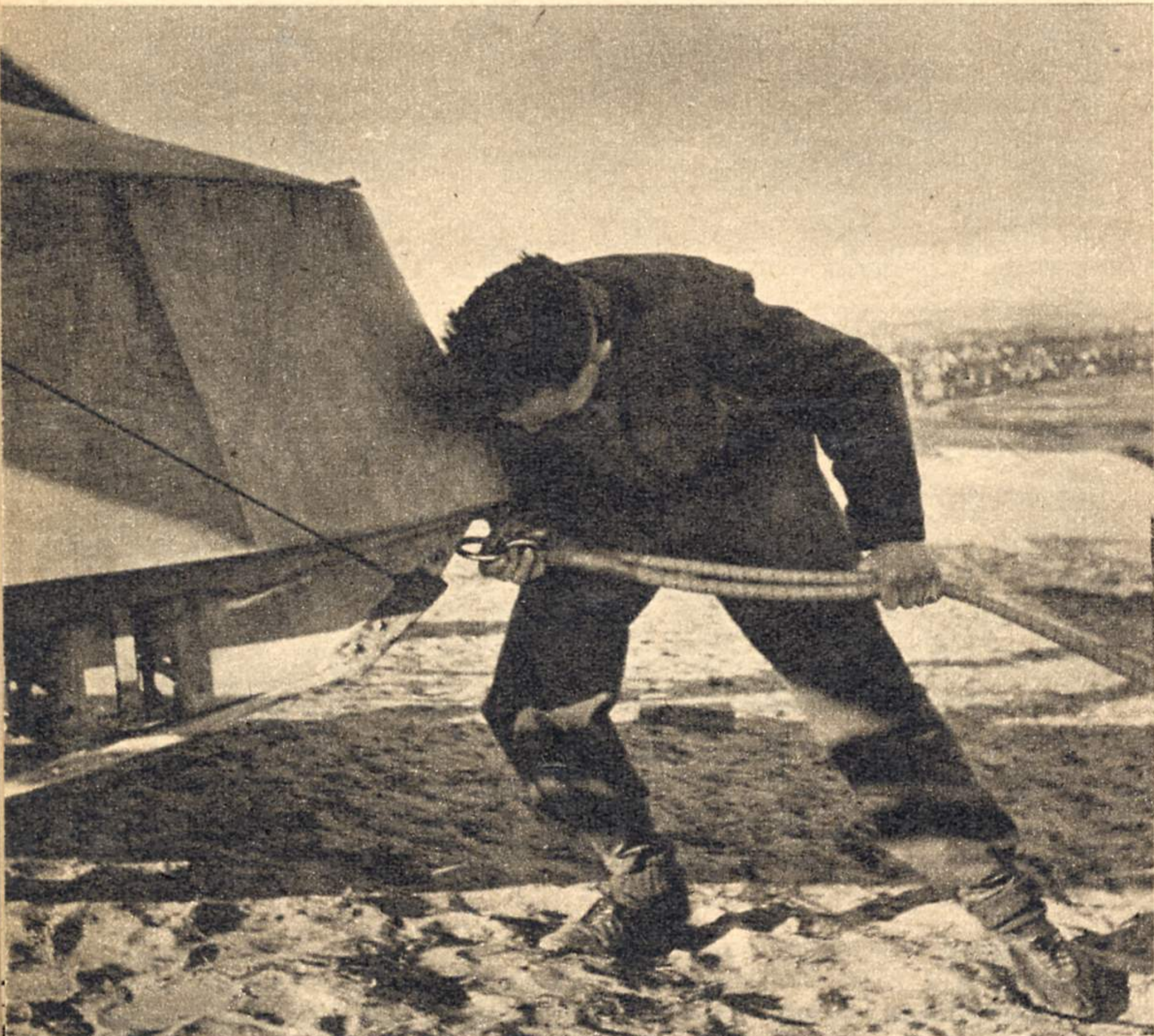
Das Startseil wird eingeklinkt. Es ist der letzte Handgriff vor dem Start; gleich wird das Kommando des Fluglehrers der Seilmannschaft das Zeichen geben
