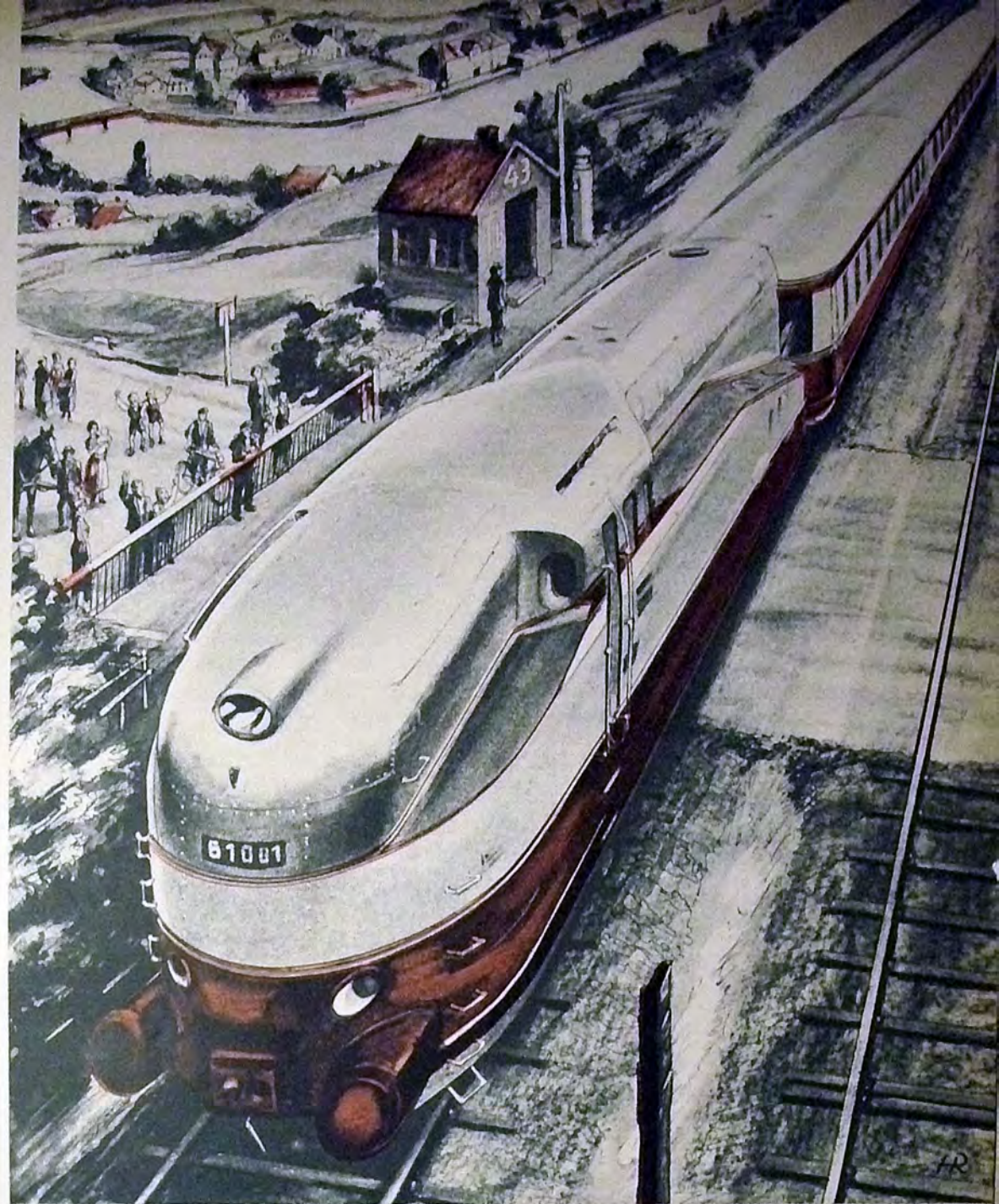
Il treno continentale dell'avvenire: treno a vapore aerodinamico. Dalla primavera del 1935 inizieranno in Germania parecchi treni a vapore a profilo aerodinamico, i più celeri d'Europa. La locomotiva a vapore a tre cilindri, con una pressione di caldaia di 20 atmosfere, giunge ad una velocità massima di 175 chilometri, trainando quattro vetture per passeggeri, di speciale costruzione leggera, con un totale di 192 posti a sedere dalla prima alla terza classe, con ambulante postale, bagagliaio, cucina e ristorante. Locomotiva e vetture hanno un rivestimento completo a profilo aerodinamico. Il treno è stato per ora messo in esercizio sulla linea Berlino-Dresda, per le comunicazioni intereuropee. Tale treno aerodinamico potrà venire usato soltanto quando i binari siano adeguati a simili velocità su tutte le ferrovie d'Europa.
