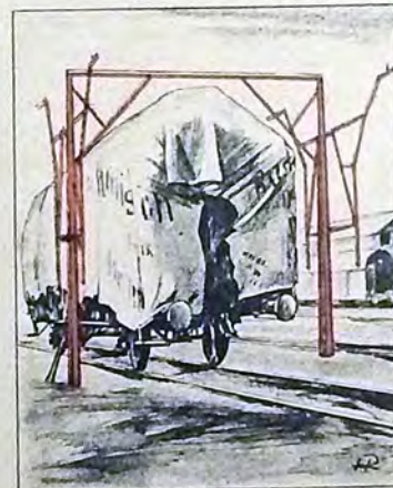
La «cruna» dei trasporti europei: il saggiaprofilo. Per i vagoni passeggeri, i bogagliai ed i carri merci coperti, il profilo è fissato dalla loro stessa costruzione. Ma i carri merci scoperti potrebbero essere caricati male, facendo sporgere parte del carico oltre il profilo regolamentare. Per impedire che tale negligenza metta a repentaglio il traffico ed il carico stesso, il profilo-tipo, in forma di sagoma vuota, si trova riprodotto nelle stazioni merci importanti. Esso segna i limiti massimi del carico di un carro merci scoperto, e soltanto quando questo sia passato «impunemente» sotto tali «torche caudine», viene ammesso a viaggiare attraverso l'Europa.
