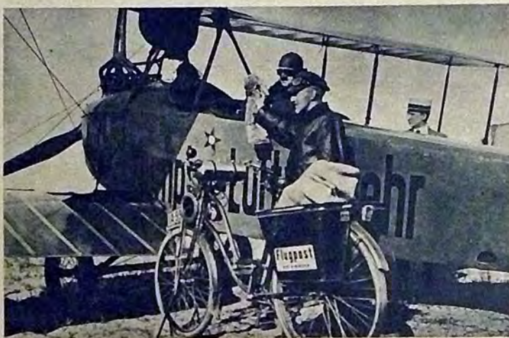
Uno dei primi velivoli spediti nell'anno 1919 sosta all'aeroporto di Berlino. È un biplano monomotore che può raggiungere la velocità massima di 120 chilometri orari. L'apparecchio impiegava sei ore per volare da Berlino a Monaco; cioè esattamente un'ora di meno di quanto ci mette oggi una littorina della Reichsbahn a coprire questo percorso. Il carico massimo dell'apparecchio non doveva superare i 250 chilogrammi, compreso il pilota ed il corriere postale. Poteva quindi trasportare solamente 100 chilogrammi di posta
