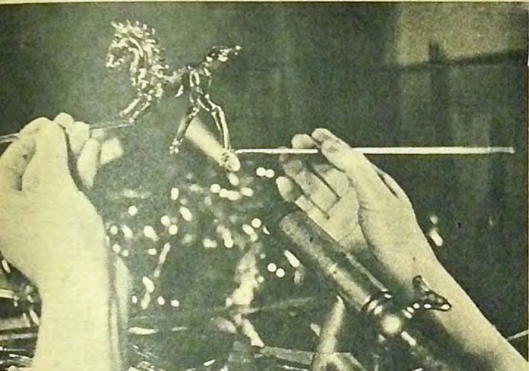
La rifinitura. Con l'ausilio della fiamma a gas, il cavallino di vetro ottiene i suoi ultimi attributi
