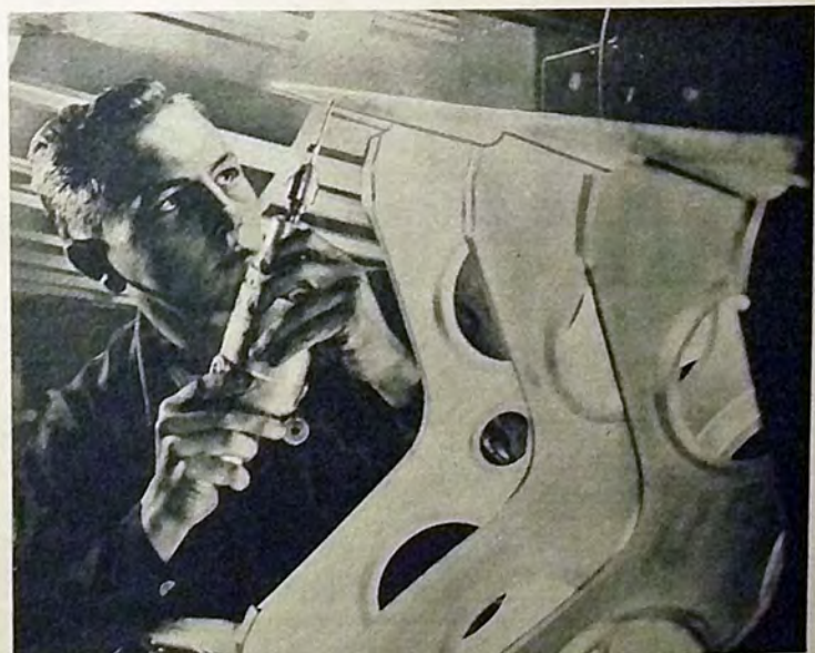
Links: Vor kurzer Zeit war er noch in der Schule... Jetzt erlernt er das Schweißen. Oben: Ein Teilstück des Rumpfes entsteht — eine Arbeit, die sonst von Männern gemacht wird
