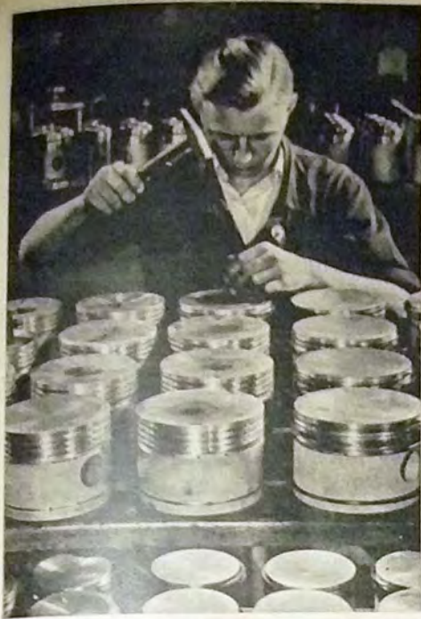
Kolben für Junkers-Motoren entstehen. Der Lehrling arbeitet an den „Jungens von Dessau“ Stantuffi per i motori Junker. L'apprendista fa parte dei cosiddetti «ragazzi di Dessau»
