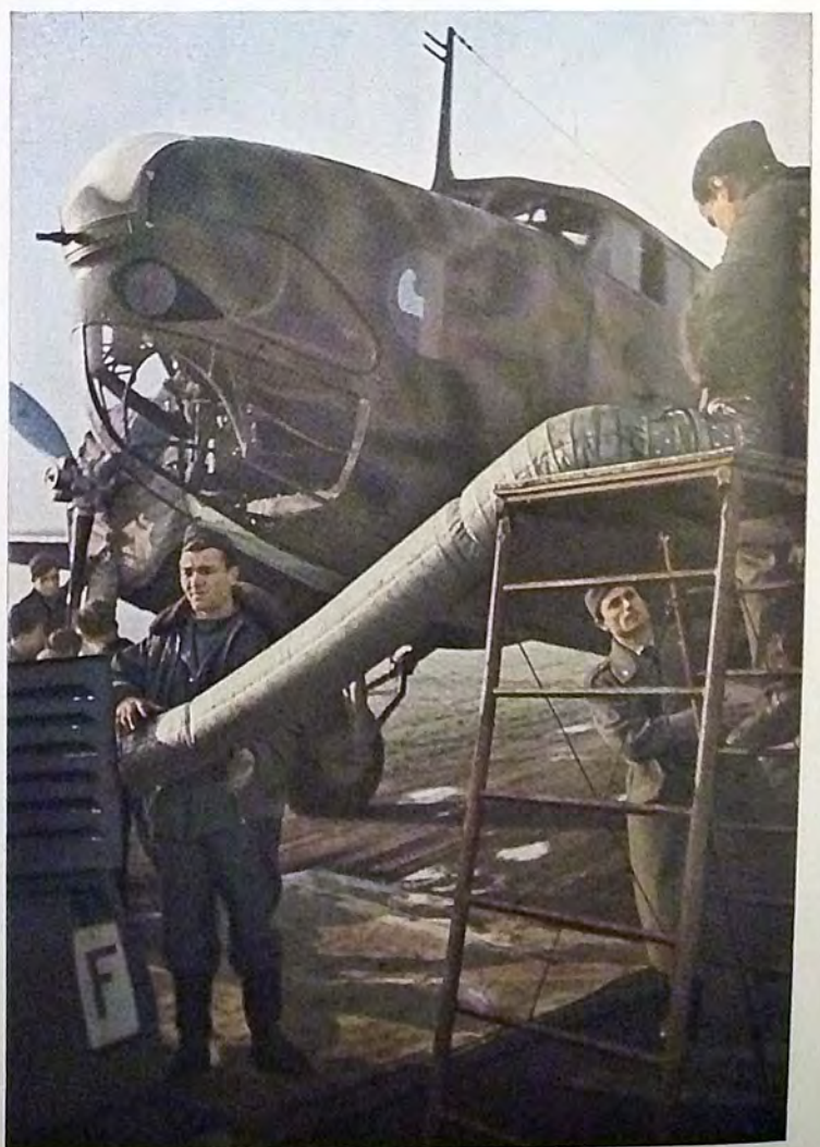
Der Heißluftschlauch. Die Maschinen werden startfertig gemacht. Heiße Luft strömt in die kalten Motoren, um sie vorzuwärmen
