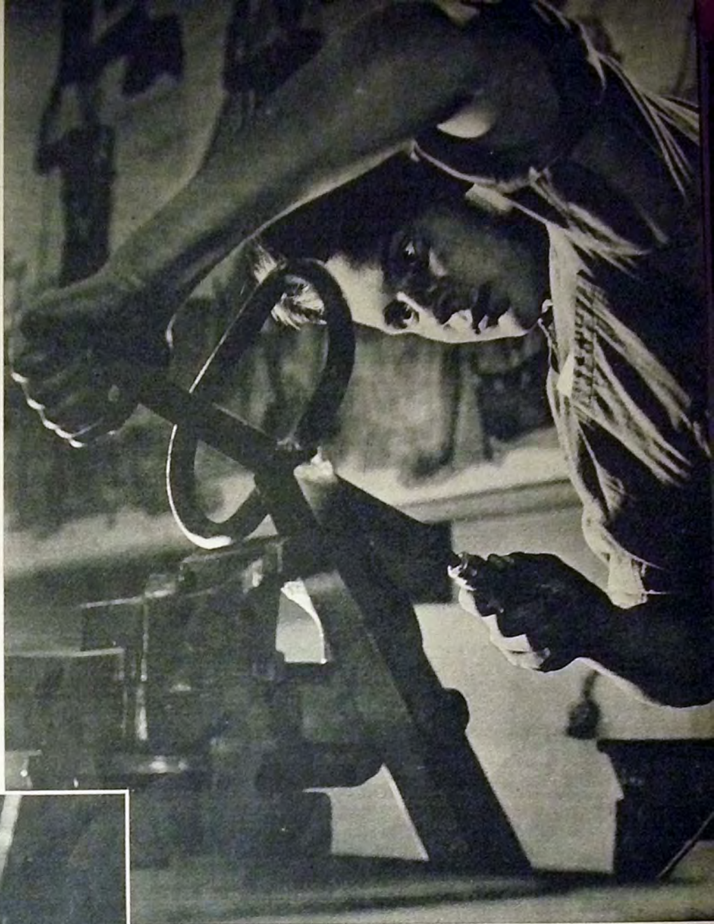
Rechts: In der Lehrlingswerkstätte: Ein Flugzeugbauer-Lehrling beim Erden eines selbsthergestellten Probestücks A destra: Nell'officina degli apprendisti: Un apprendista mentre si lima un pezzo di propria costruzione
