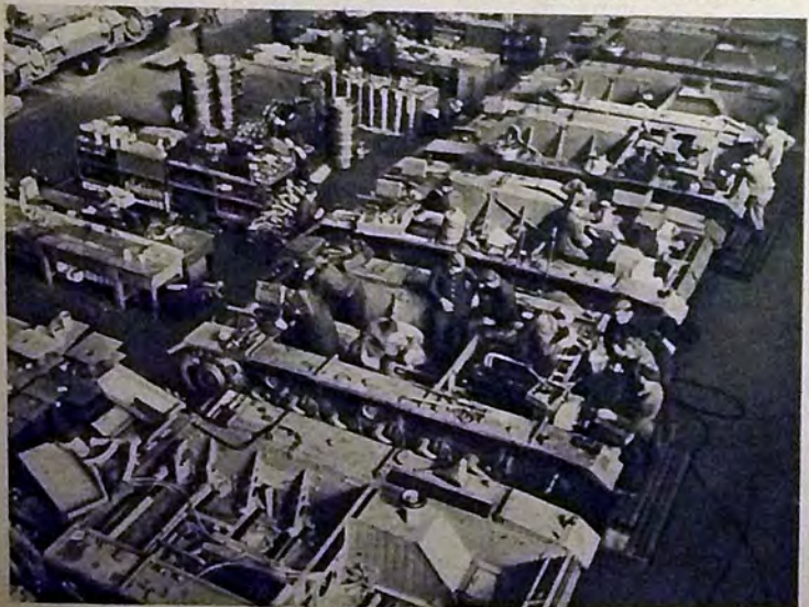
3. ... Panzerwagen, die „gefüllt“ werden. Hier wird schon mit dem Einbau der Maschinerie begonnen. Ist der Panzerwagen aus diesem Herstellungsstadium heraus, wird er... ... carri armati che vengono «riempiti». Qui s'inizia il lavoro del montaggio del meccanismo. Quando il carro armato è giunto a tal punto di costruzione...
