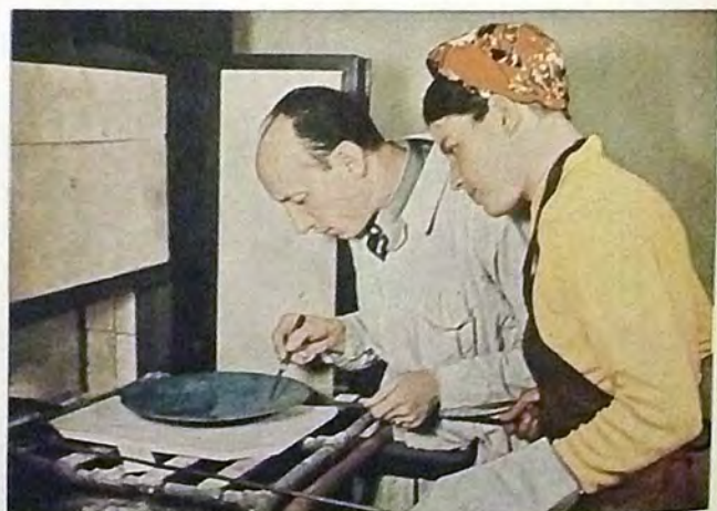
Un piatto pronto allo smalto viene introdotto nel forno, dal quale si toglie dopo la tempera, come dimostra la lastra fusa (qui sotto)
