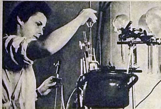
Der Kochtopf als Sezierlisch. Bei der Stickstoff-Bestimmung erkennt der Wissenschaftler den inneren Aufbau der Eiweißstoffe
