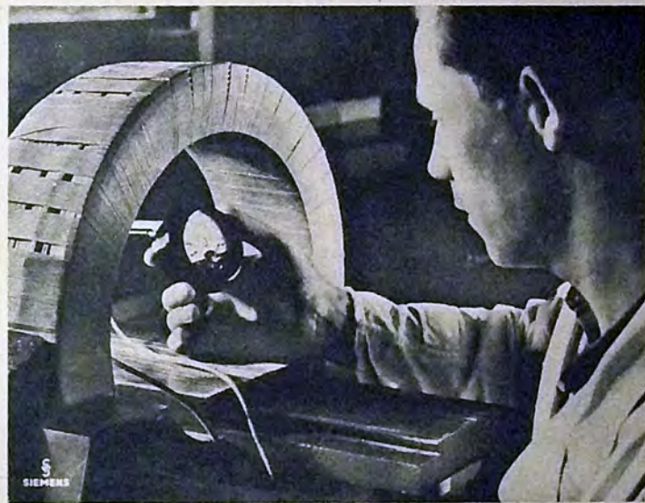
Il grado di precisione degli strumenti di misura è premessa indispensabile nella tecnica delle misure. I rumori di correnti vagabonde possono risultare dai sbagliati. Qui viene esaminato uno strumento da quadro di distribuzione in un potente campo magnetico per assodare se l'esattezza dell'istrumento di misura viene influenzata in un modo qualsiasi.
