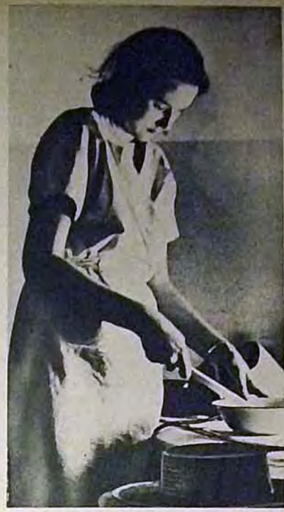
In der Gipsküche wird die Grundform eines Hutes in Gips getaucht. Über das hartgewordene erste Modell werden alle weiteren Bestellungen gearbeitet. Oben rechts: Mit Heißluft gedämpft. In einem Raum wird das Material gedehnt, geformt und gezogen, bis es geschmeidig sich den Händen der Gehilfinnen fügt
