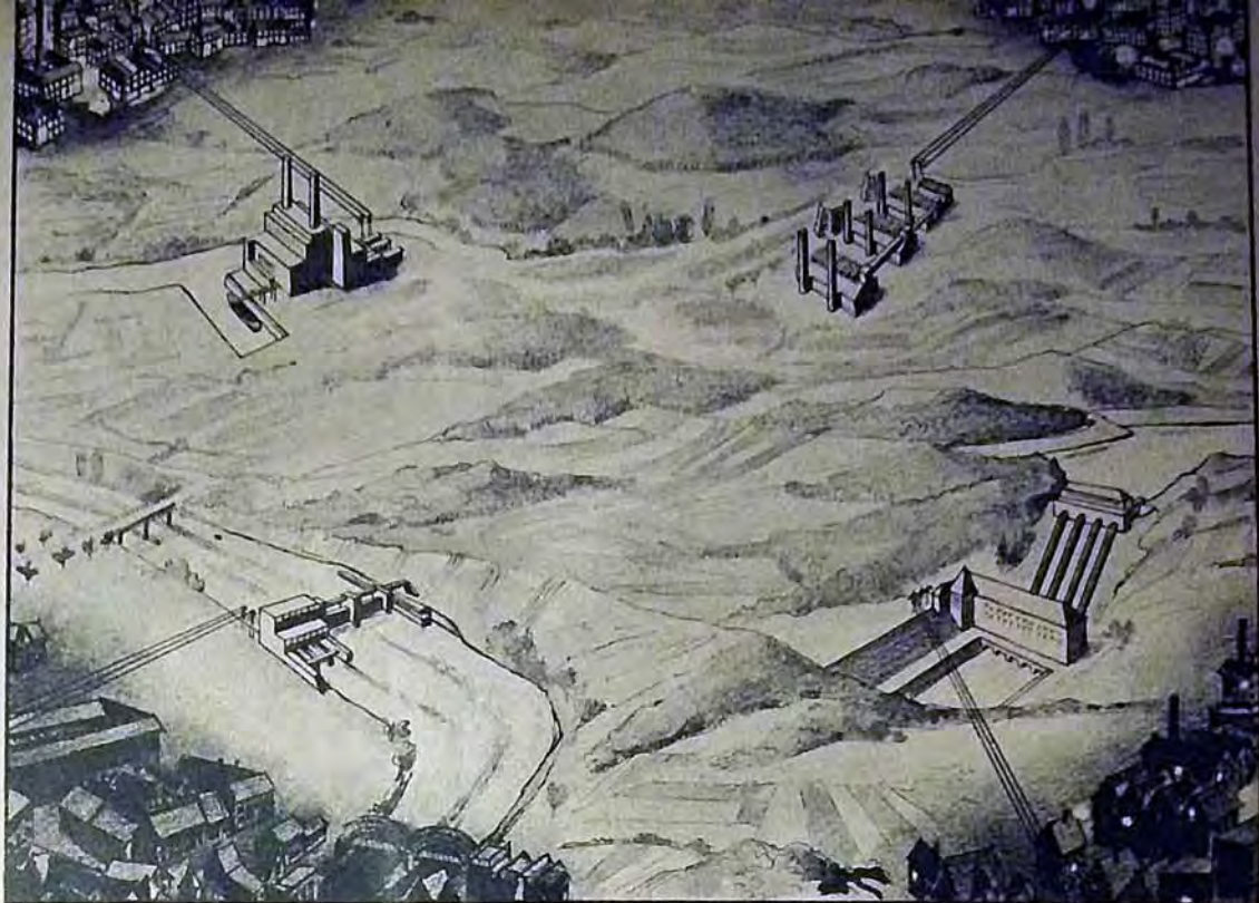
Quanto non è mal raggiungibile da uno solo. . . Quattro settori dell'approvvigionamento e quattro impianti elettrici con singolo funzionamento. L'impianto elettrico a carbone fossile (in alto a sinistra) e quello a lignite (in alto a destra) sono in grado di fornire in ogni momento l'energia richiesta, ma soltanto se la loro attrezzatura permette anche il massimo d'aggravio che viene raramente richiesto; in molte ore del giorno, a seconda del variante fabbisogno di corrente condizionato ai periodi dell'anno, le macchine vengono appena sfruttate e quindi non rendono. L'impianto elettrico del fiume (in basso a sinistra) e quello dell'opera di sbarramento (in basso a destra) possono fornire la corrente soltanto se c'è l'acqua. Ma disgraziatamente il quantitativo dell'acqua che ci dà la natura ed il fabbisogno di corrente dell'Europa, non tengono la bilancia in equilibrio. La soluzione ideale sarebbe la costituzione di una barra collettiva, che collegasse i quattro impianti fra loro
