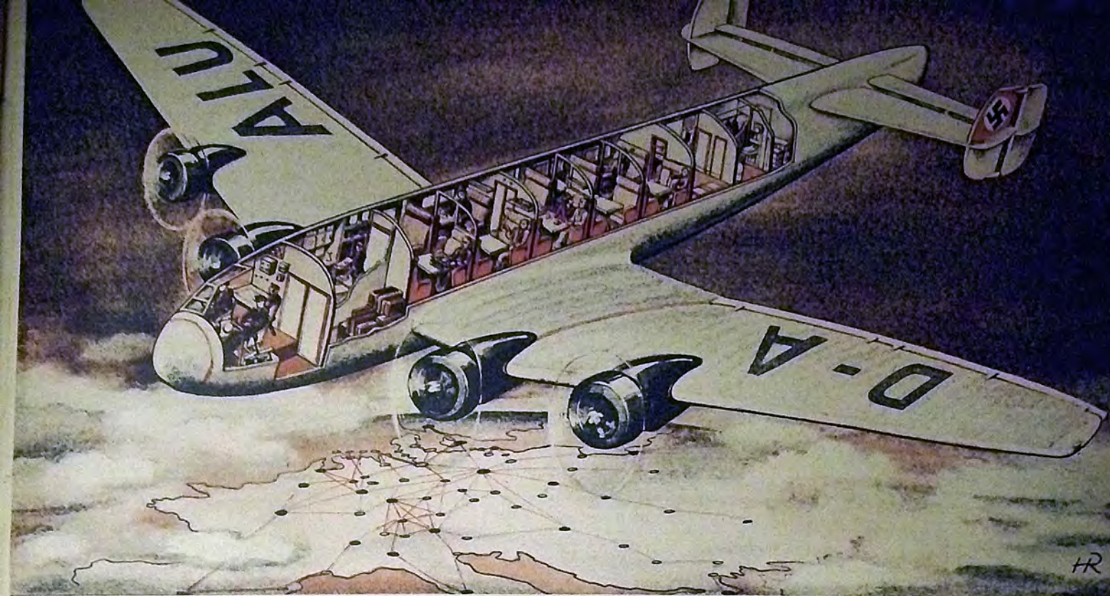
Provvisto di ogni comodità. Il Ju 90, l'apparecchio destinato al traffico su lunghi percorsi, può trasportare 40 passeggeri ed è provvisto di ogni comodità: scompartimenti per fumatori e non fumatori, bagagliaio, gabinetti, riscaldamento, ventilazione e servizio ristorante. Mitropa. Il doppio posto di pilotaggio, i dispositivi per il volo e l'atterraggio cieco, il regolatore di rotta Siemens ed infine gli apparecchi radio nella cabina del marconista garantiscono la massima sicurezza di volo.
