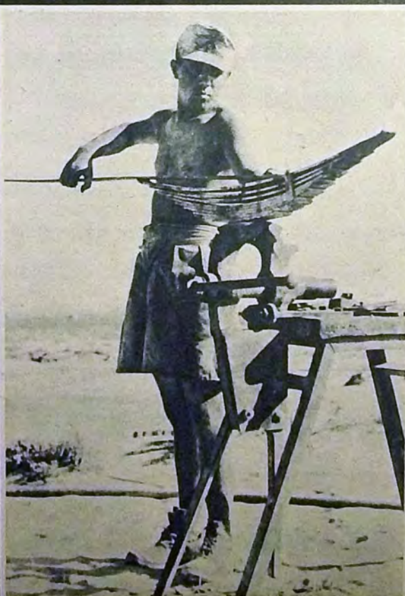
Sul terreno sassoso del deserto, rotture di balestre sono una cosa abituale. Ma i fabbri dispongono di una grande quantità di molle di ricambio, che permettono loro di eseguire con la massima rapidità qualsiasi riparazione
