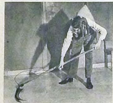
Il falciatore della vecchia scuola . . . Dalla posizione del corpo di questo contadino, il cui impiego di energia viene esattamente misurato, si riconosce lo sforzo causato dal lavorare con una comune falce. Lavora meglio . . .
