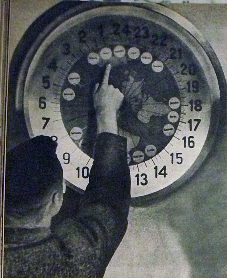
L'orologio «mondiale». Esso si trova appeso nella sala di trasmissione della stazione radio e segna l'ora esatta del giorno e della notte delle maggiori metropoli del mondo. Il disco interno compie un giro al giorno; basta uno sguardo per sapere dove sia giorno o notte e per mantenere l'orario delle trasmissioni con esattezza cronometrica
