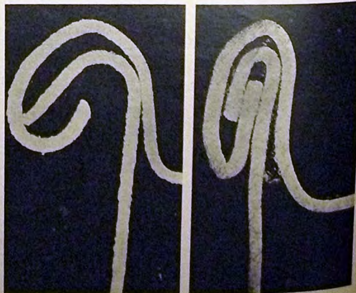
Il barattolo di conserva, ovvero il problema della chiusura ermetica. Due ingrandimenti microscopici della chiusura di un barattolo di conserva: a sinistra vediamo una chiusura difettosa, ed apparentemente a tenuta d'aria, mentre quella a destra è ermetica e perfetta. Fotografia del Cnr
