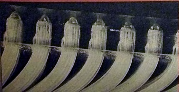
Setole di «Perlon» nello spazzolino da denti. Come mostra l'ingrandimento, anche dopo un lungo uso esse sono ancora quasi intatte
