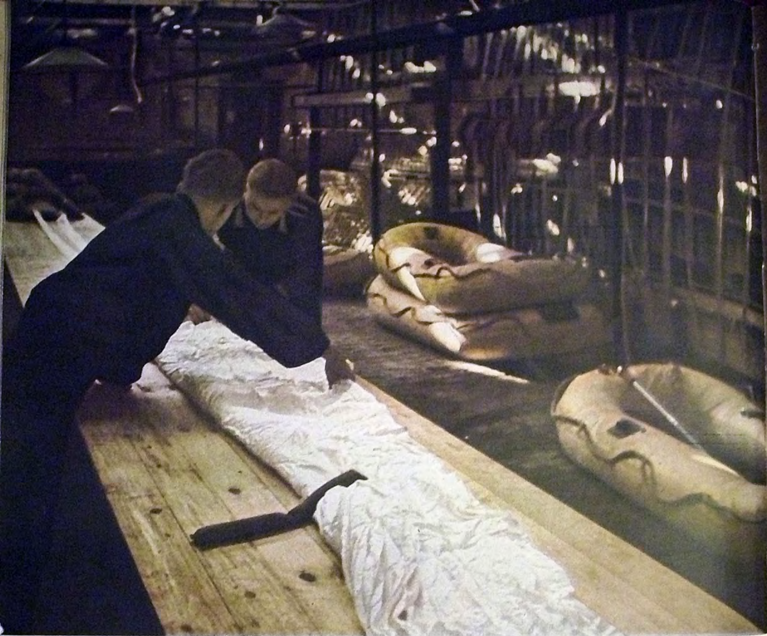
Für alle Fälle! Die Fallschirme werden in hohen Windkammern getrocknet und auf langen Tischen neu gefaltet und gebrauchsfertig gemacht. Floßsäcke stehen aufgepumpt in der Ecke
