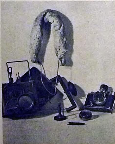
Dies ist die von Hans Hass konstruierte Unterwasser-Kamera. Für den Gebrauch wird der Apparat in das Gehäuse gesteckt, das links in geöffnetem Zustand zu sehen ist. Eine Gummidichtung sorgt dafür, daß das Wasser nicht eindringen kann
