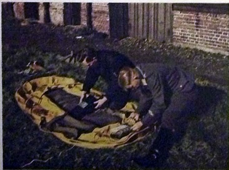
Aus dem Floßsack ist die Luft entwichen. Eine neue Flasche mit grüner Farblösung wird am Boden befestigt, die Sauerstoff-Flasche ist frisch gefüllt. Dann wird . . .
