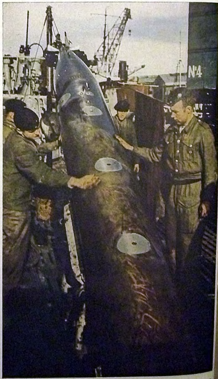
Die wichtigste Fracht wird übernommen. Ein Torpedo wird eingefettet. Die Fettschicht bewahrt ihn vor den Einflüssen der Feuchtigkeit
