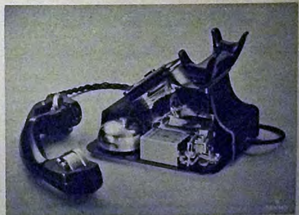
Im Schnitt sind die aus Preßstoff bestehenden Teile des neuen Siemens-Fernsprechers gut zu erkennen.
